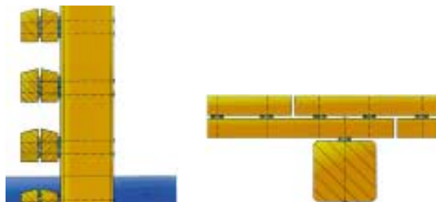
Nieuw: remmingwerk met samengestelde gordingen
